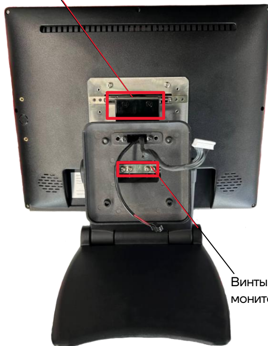
Рисунок 9. Дополнительный монитор, зафиксированный на стойке
