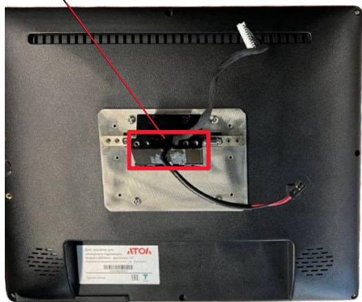
Рисунок 8. Кабели для подключения дополнительного монитора к POS-терминалу
