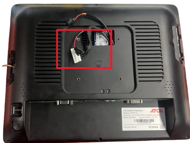
Рисунок 10. Кабели POS-терминала для подключения дополнительного монитора
